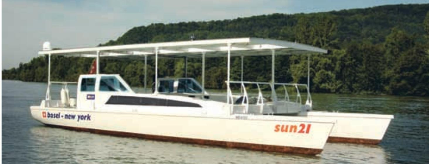
Die «sun21» ist vierzehn Meter lang und sechs Meter breit. Mit Solarzellen, Batterien und Elektromotoren ausgerüstet, fährt der Katamaran von Basel auf einer Strecke von rund 7000 Seemeilen nach New York. Auf Lanzarote haben die fünf furchtlosen Besatzungsmitglieder einen Zwischenstopp eingelegt.
